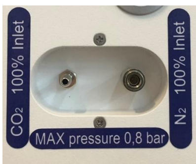
Afbeelding 11.1 Gasinlaten aan de achterkant van de MIRI® II-12 IVF-incubator met meerdere kamers
